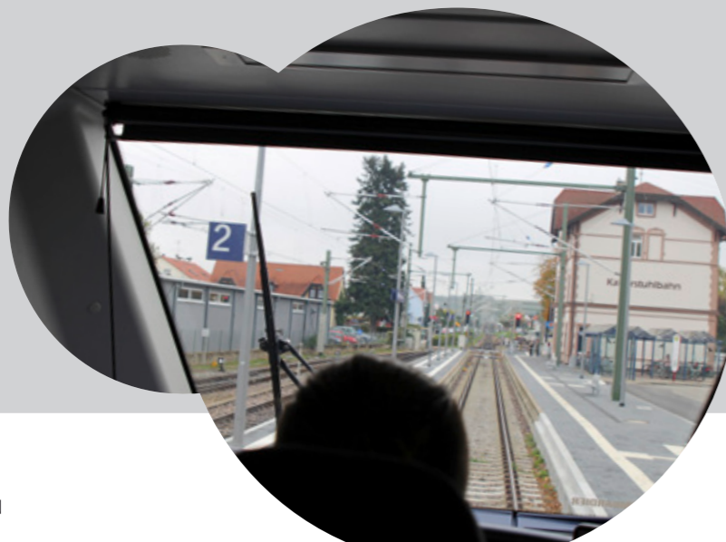
Blick aus einem Elektrotriebzug auf die neu errichteten Oberleitungsanlagen im Bahnhof Endingen
