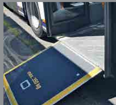
Rollstuhlrampen lassen sich bei Bedarf einfach ausklappen
